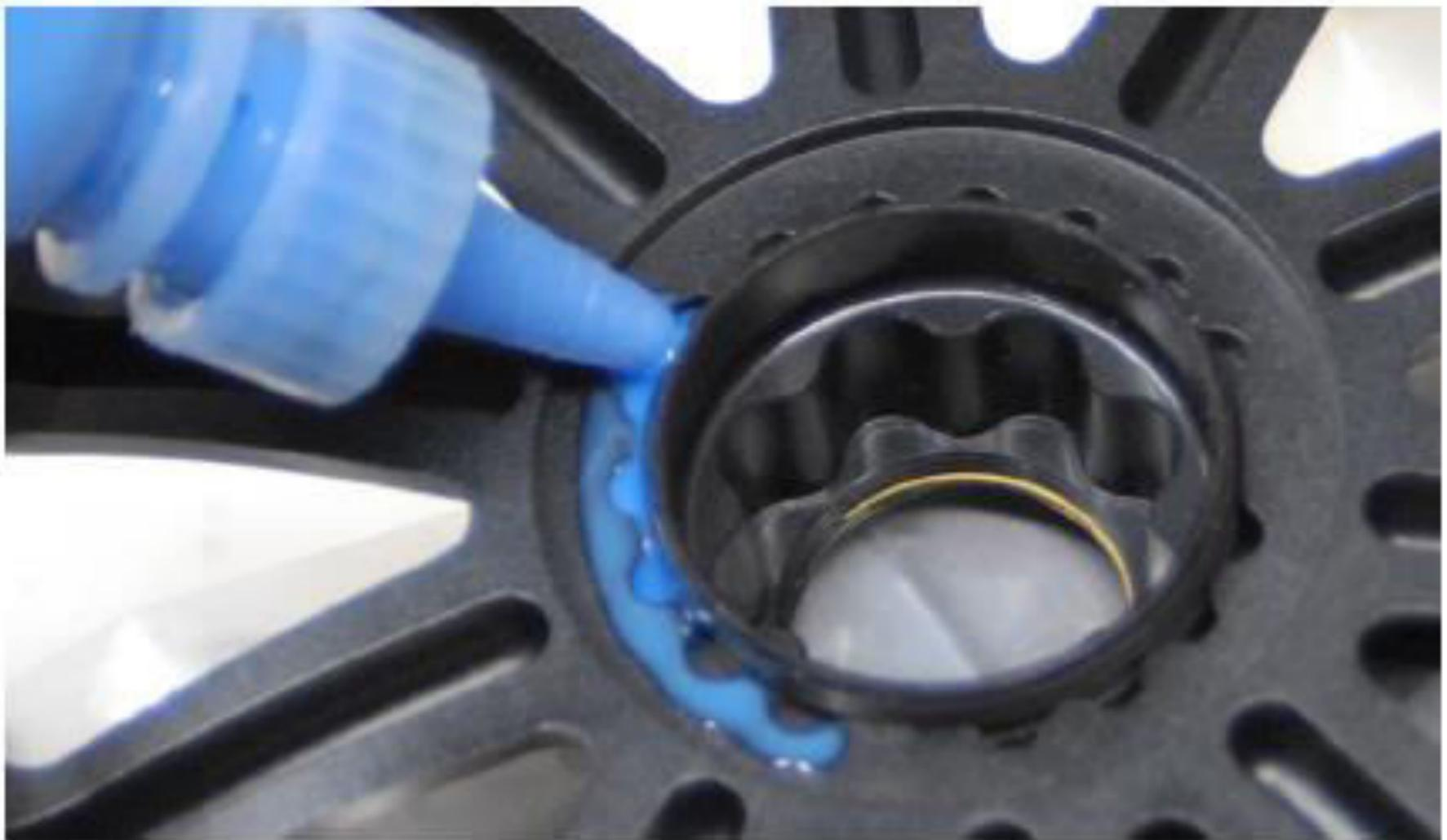
Loctite 242 (синий) Нанесите Loctite в пространство между шатуном и пауком, и на резьбу шатуна для стопорного кольца.
